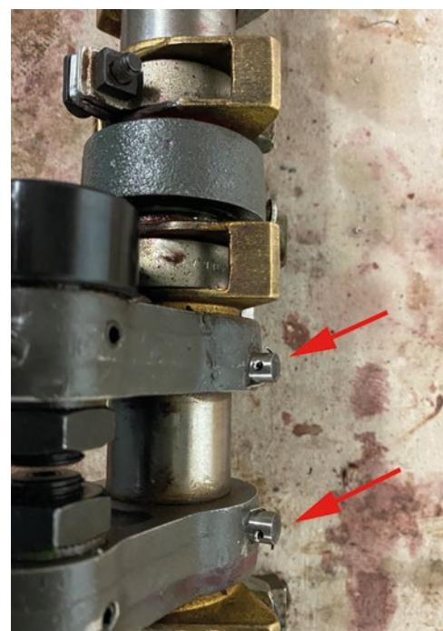
**Abb. 2: Ausgetauschte Kegelstifte (rot markiert) zur Fixierung in Steuerwelle.**
