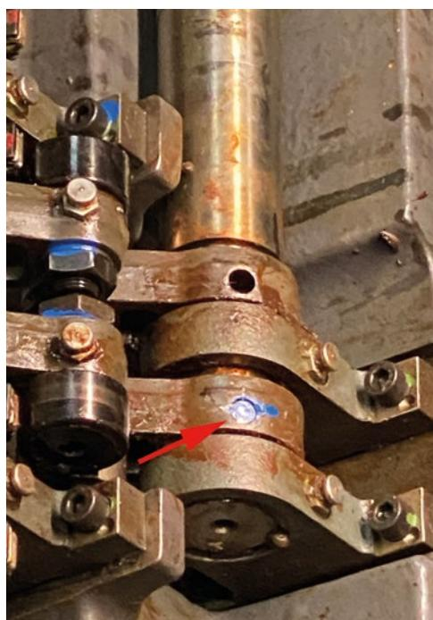
**Abb. 1: Kegelstift (roter Pfeil) zur Fixierung in Steuerwelle.**
