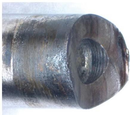
Abb. 4: Bruchfläche am Gewindegrund des Kegelstiftes.
