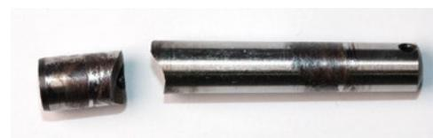
**Abb. 3: Gebrochener Kegelstift mit den Maßen 8 x 75 mm.**
